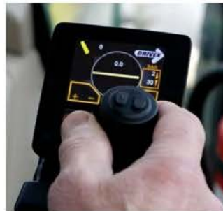
Styrsystem med joystick för exakt reglering av hyvelbladets läge och marktryck.
